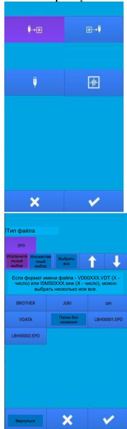
2) Нажать клавишу USB-флеш-накопителя , чтобы отобразить интерфейс файла USB-флеш-накопителя, как показано на рисунке справа.
