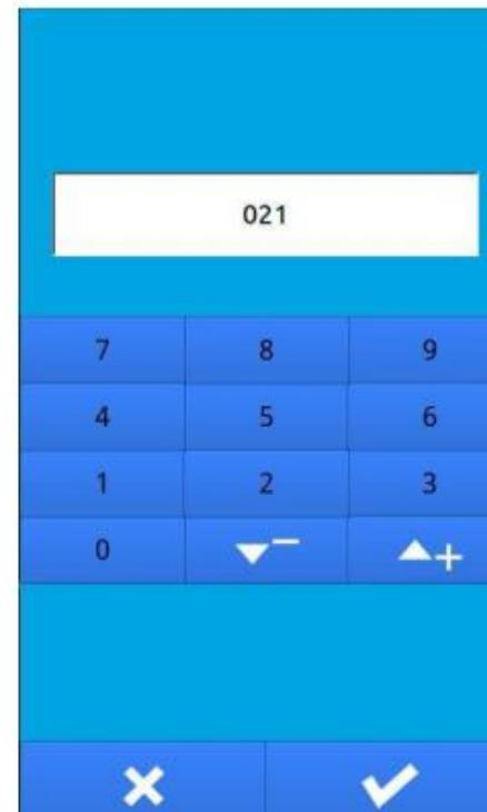
3) После нажатия клавиши на рабочей панели, вход в интерфейс номера файла (Enter File Number Interface) отображается как показано на рисунке справа.
