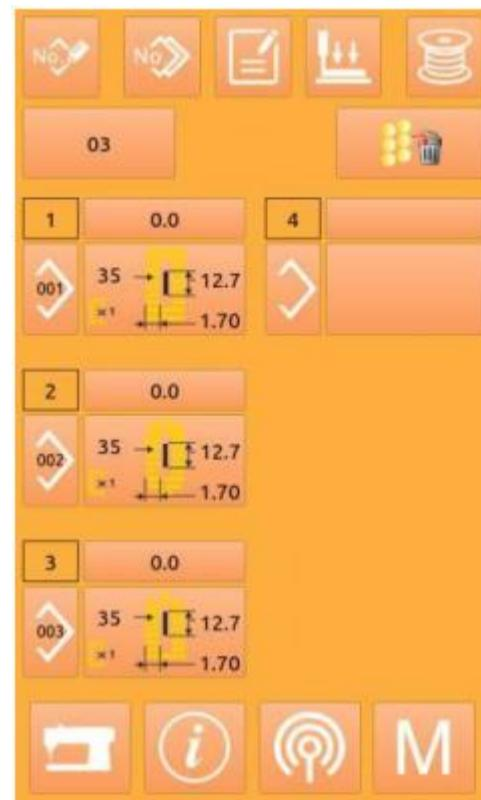
На рисунке справа показано редактирование швейных данных шаблона прострочки. См. ввод данных непрерывной прошивки.
