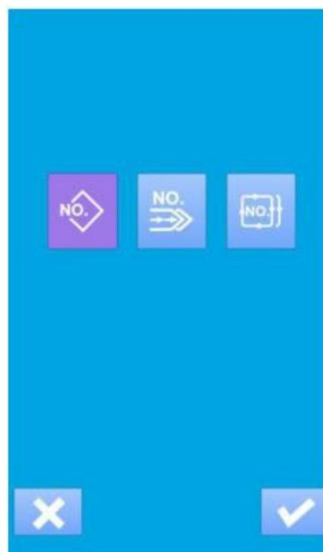
После определения типа шитья нажать
